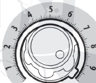
Рис. 8.6.1. Дожигание сварочной проволоки.
