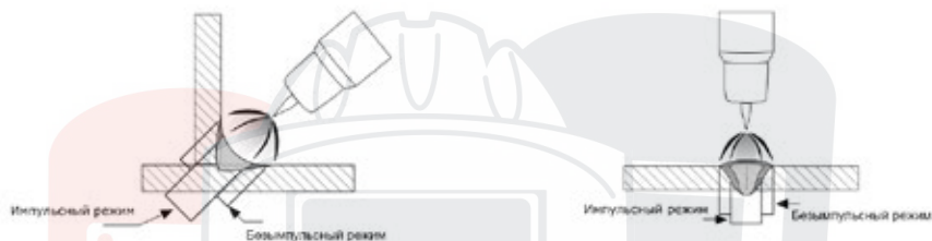
Рис. 8.7. Выделяемое тепло в импульсном и безимпульсном режимах.
