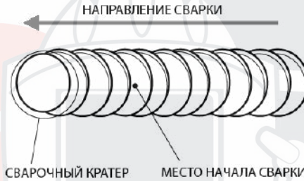
Рис.8.1.2. Начало сварки при смене электрода.
