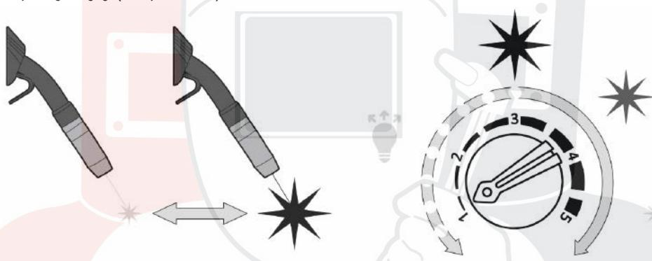
Рис. 10.2. Выбор чувствительности датчиков.
