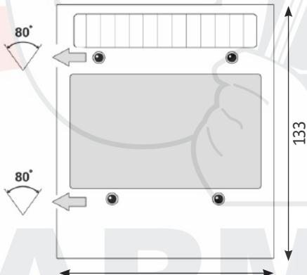
Рис. 10.1. Угол обзора датчиков.
