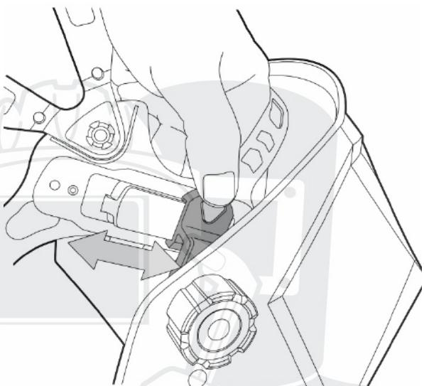
Рис. 8.7. Регулировка «ближе/дальше».
