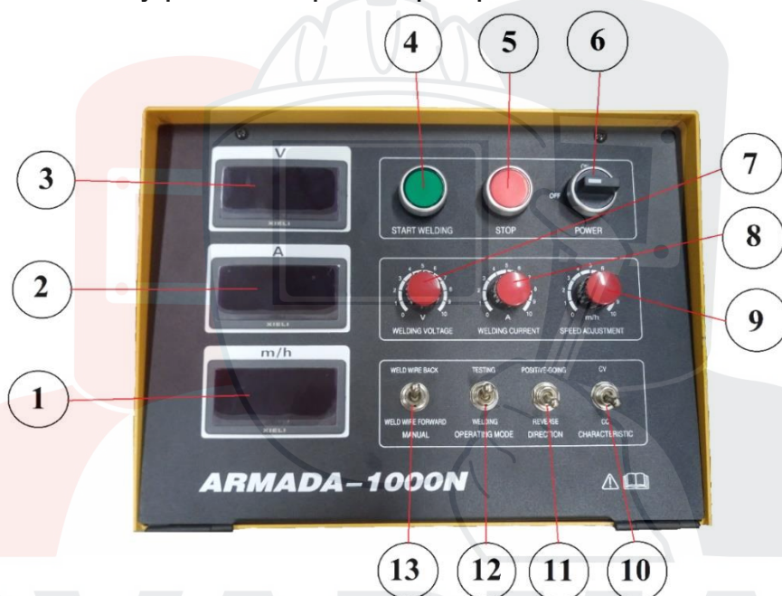
Рис. 6 Органы управления БУ сварочного трактора ARMADA.
