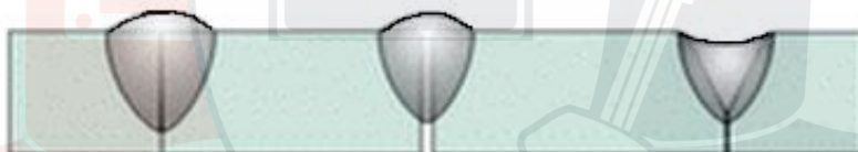
Рис. 17 Влияние подготовки кромок на форму шва.
