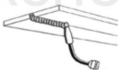
Рисунок 23. Сварка в потолочном положении
