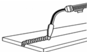
Рисунок 22. Сварка в нижнем положении
