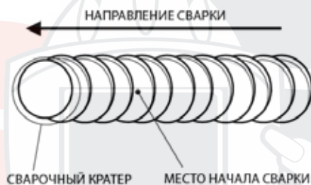
Рис. 12.4. Начало сварки при смене электрода.
