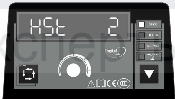
Рисунок 3. Установка времени горячего старта. Диапазон 0.2~2 сек.
