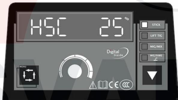
Рисунок 2. Установка тока горячего старта. Диапазон 0 ~ 50%
