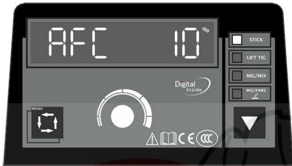
Рисунок 4. Установка форсажа дуги. Диапазон 0–80%
