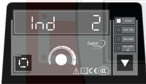
Рисунок 5. Установка индуктивности. Диапазон – 2 ~ 2
