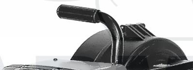
Рис. 2.1 Ручка для переноски механизма подачи проволоки
