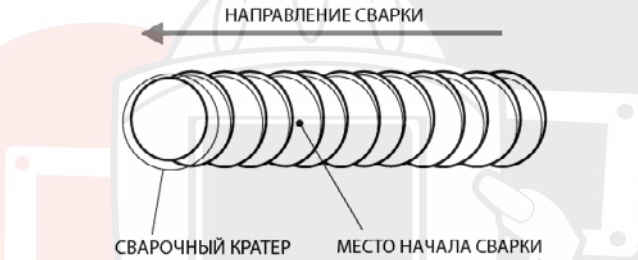
Рис. 11.6. Начало сварки при смене электрода.
