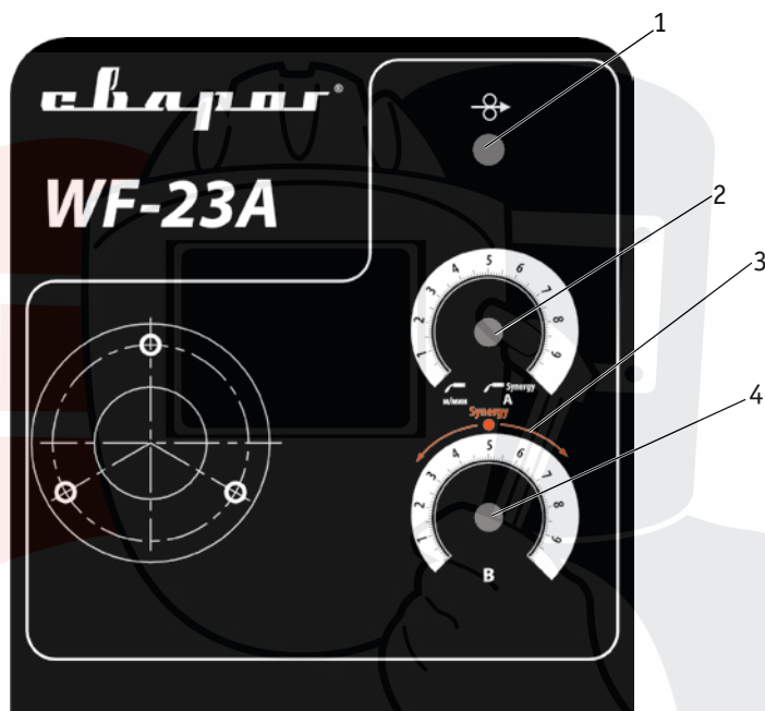
Рис. 7.2. Передняя панель механизма подачи проволоки.
