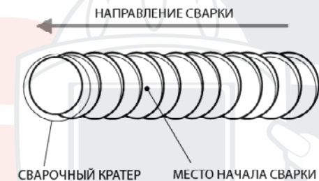
Рис. 9.4. Начало сварки при смене электрода.
