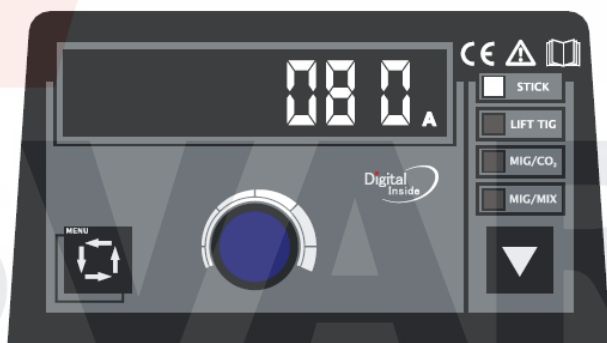
Рисунок 2. Установленный ток с включенной функцией VRD в режиме STICK
