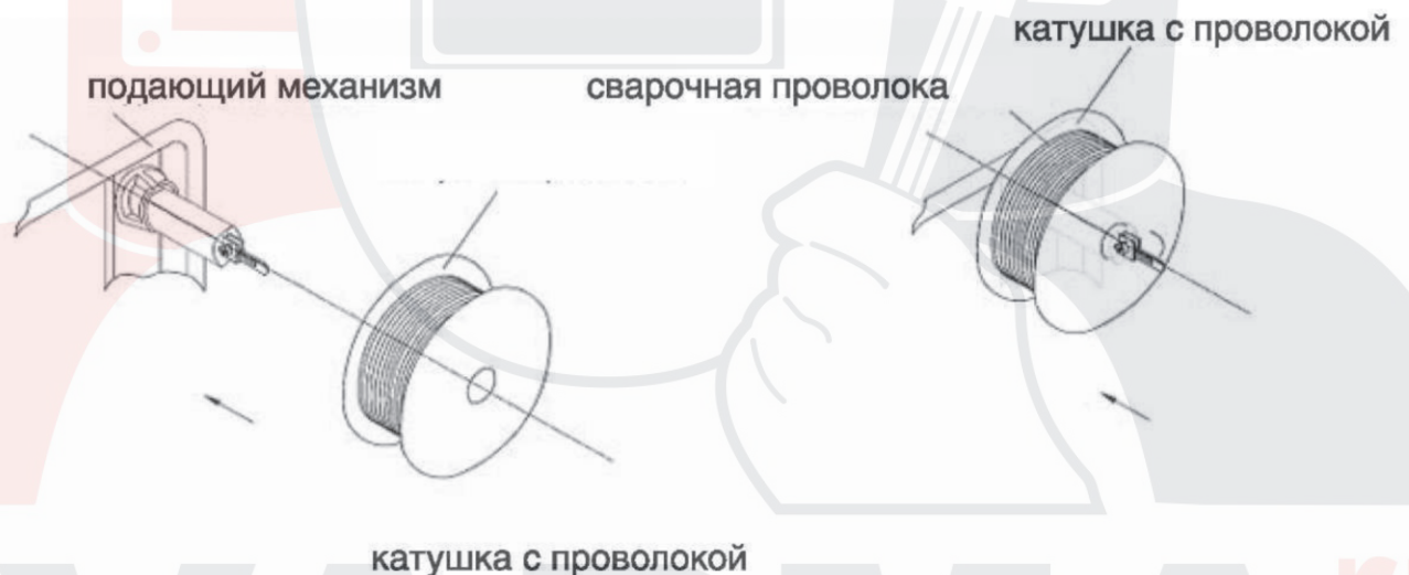
Рис. 5.3. Установка кассеты со сварочной проволокой
