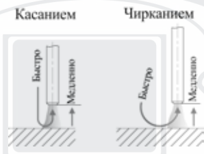
Рис. 7.2. Способы зажигания сварочной дуги.
