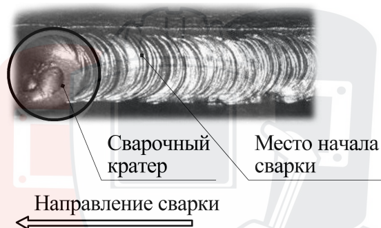
Рис. 7.5. Начало сварки при смене электрода.
