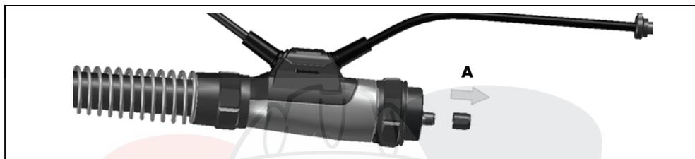
**Рис. 5** Снятие накидной гайки
