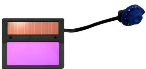
Автоматический светофильтр сварщика это средство защиты нового поколения, использующее последние достижения и разработки. Основные элементы светофильтра – многослойный составной экран с жидкокристаллическим слоем, инфракрасные датчики, элементы солнечных батарей с дублирующими батареями, микроэлектронная схема управления. Даже неисправный светофильтр – «хамелеон» обеспечивает постоянную защиту от УФ/ИК излучений благодаря постоянному фильтру (защита основана на частичном отражении лучей).
