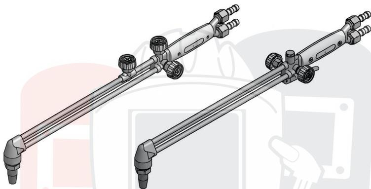
Резак состоит из головки, вентилей горючего газа (ГГ), подогревающего кислорода (КП), режущего кислорода (КР) (или клапана с рычагом), ручки и соединительного блока с гайками и ниппелями. Все элементы резака соединены между собой трубками (соединение неразборное).
