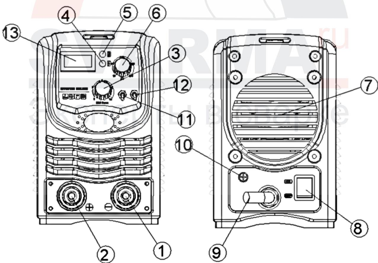
1. Клемма «-», для подключения зажима массы.
