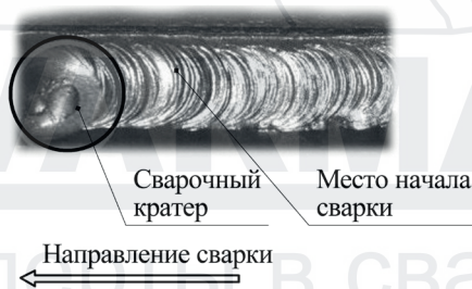
Рис. 8.4. Начало сварки при смене электрода.
