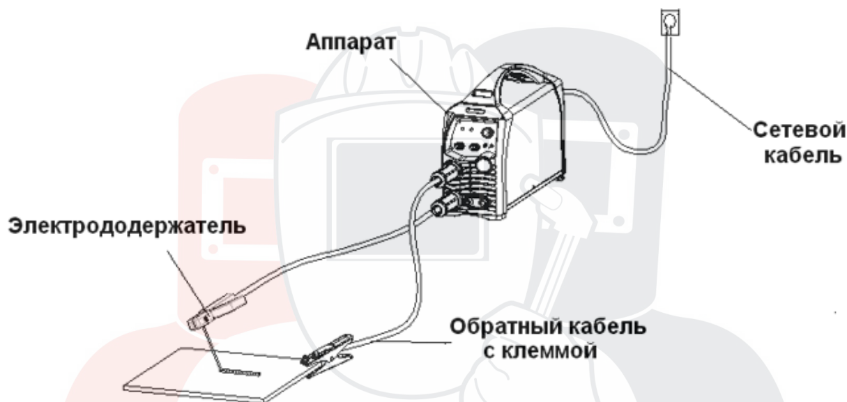
Рисунок 6.3 Схема подключения оборудования для ММА сварки.
