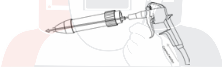
Рис. 8.4. Схема продувки горелки.
