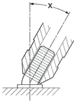
Испытание на изгиб служит простым испытательным средством приваренного образца, а также проверки правильности выбора сварочных параметров.
