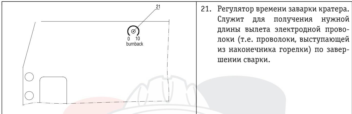
21. Регулятор времени заварки кратера. Служит для получения нужной длины вылета электродной проволоки (т.е. проволоки, выступающей из наконечника горелки) по завершении сварки.
