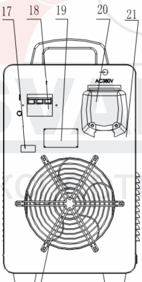
17. Разъем для подключения кабеля подогревателя газа
