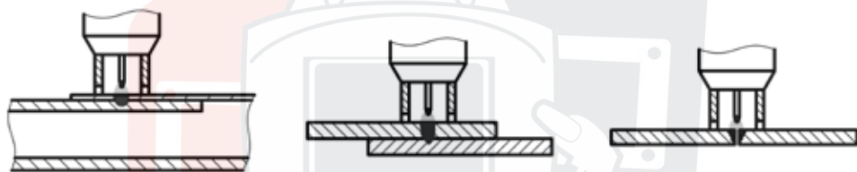
Рис. 9.3. Основные виды соединений при Spot сварке.
