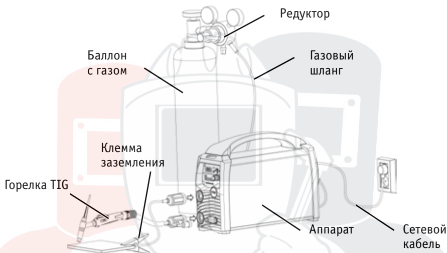
Рис. 8.1. Схема подключения оборудования.
